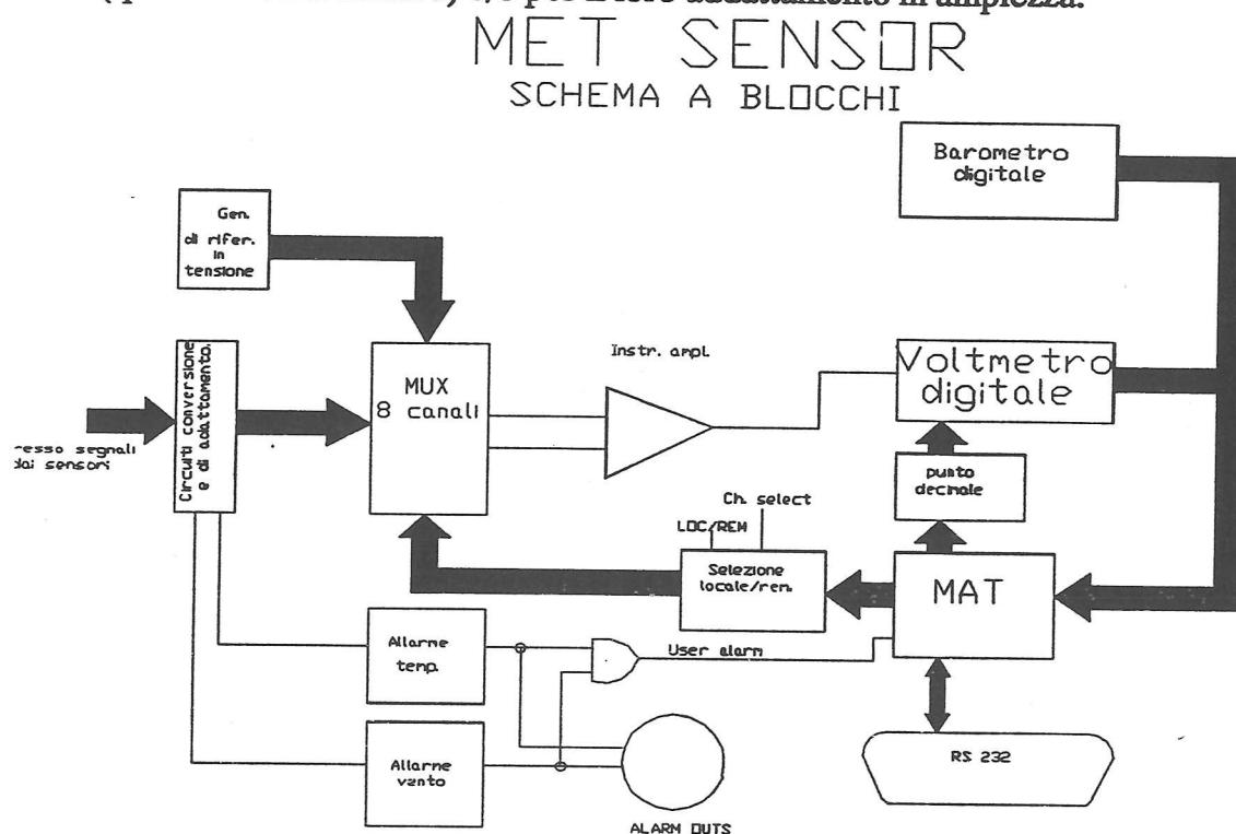
Fig. 3 Schema a blocchi.
