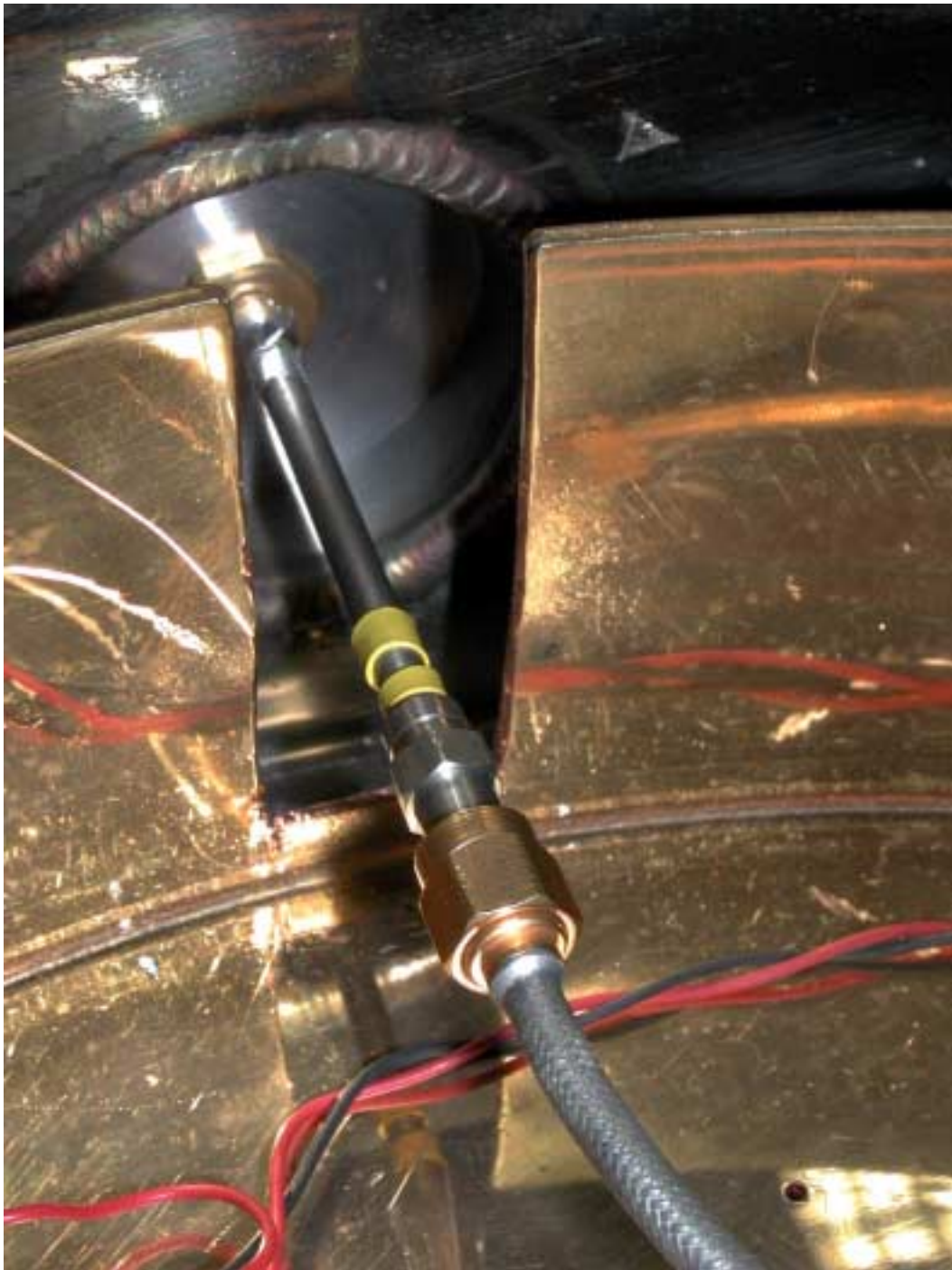
Figura 4.3: Particolare dell'interno del Dewar; cavetto coassiale SS141 in acciaio inox
