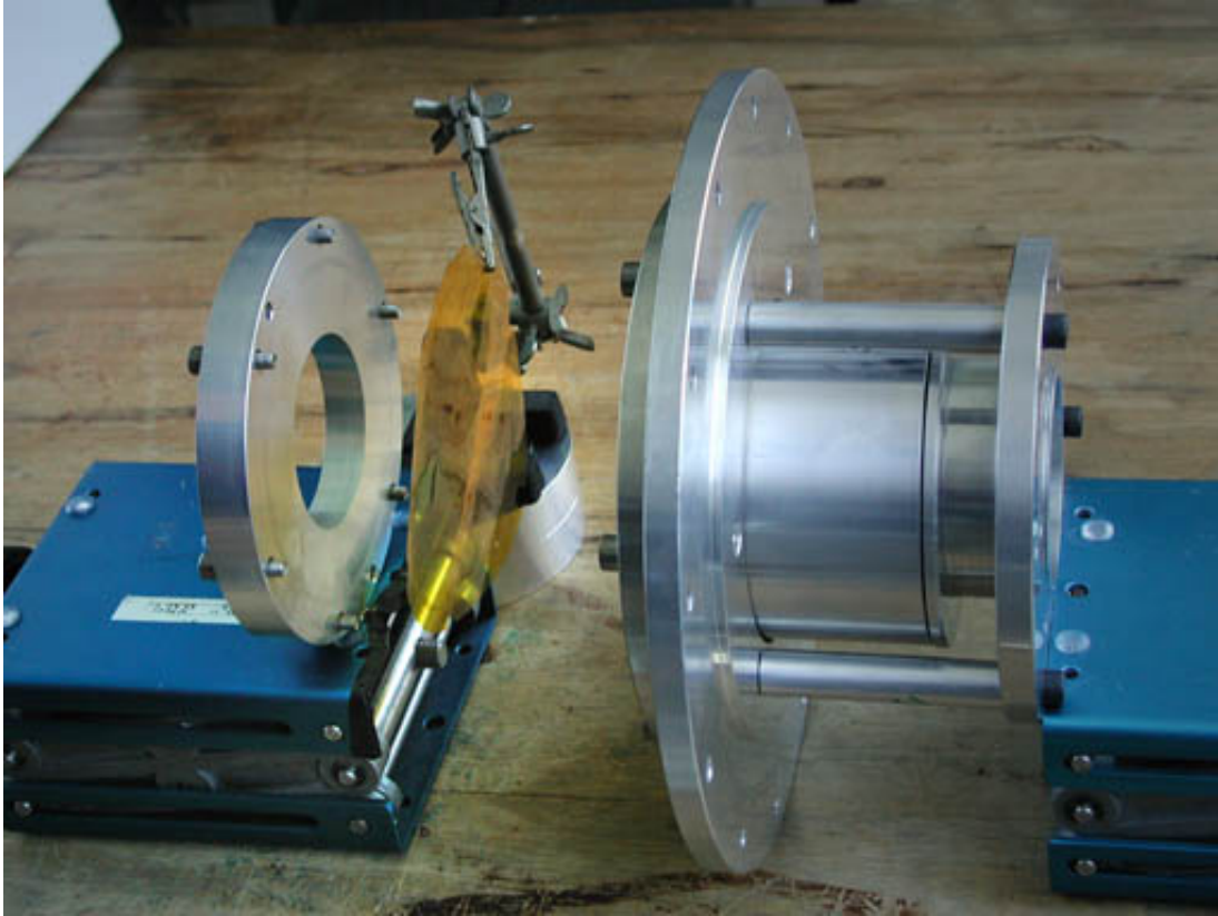
Figura 4: Spaccato della finestra a vuoto: al centro si nota la finestra in kapton di 25 \mu\text{m} di spessore.
