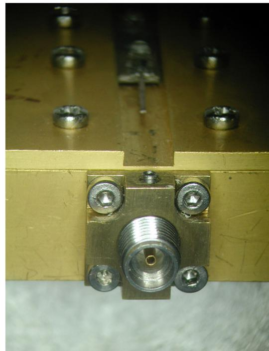
Figura 2.1 Connettori SMA (sx) e K (dx) , si noti che la flangia del connettore SMA è corpo unico con il connettore
