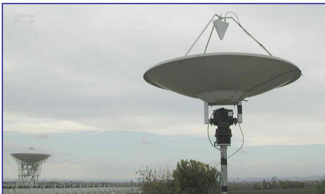
Figura 3 – Il rotore e l'antenna del sistema Az-EI
