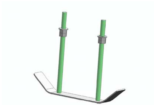
Fig.05 Inserimento dadi e rosette nella piastra di blocco
