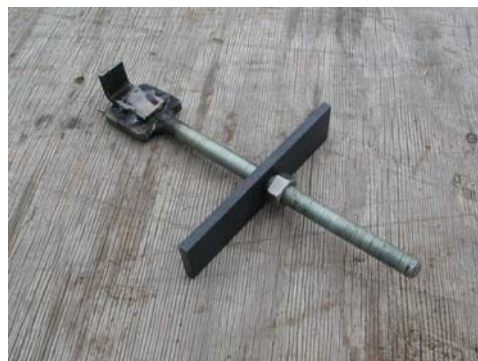
Fig.09 Morsa speciale per bloccaggio dima
