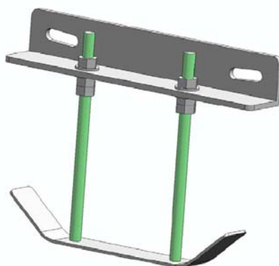
Fig.06 Montaggio piastra di blocco
