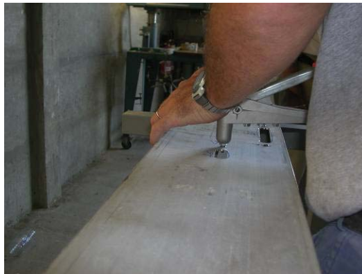
Fig.2-22 Inserimento dei rivetti
