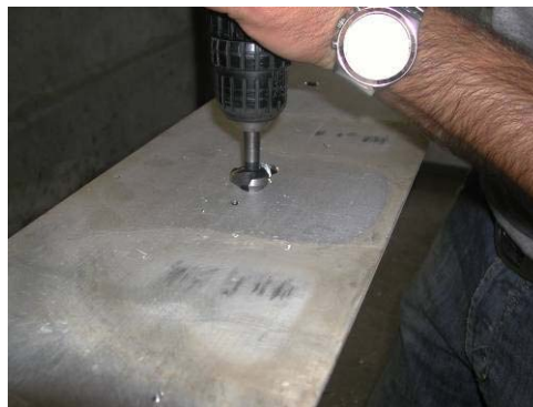
Fig.2-18 Svasatura dei fori
