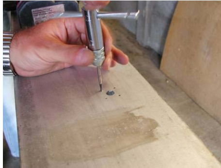
Fig.2-21 Filettatura fori diametro 2,3
