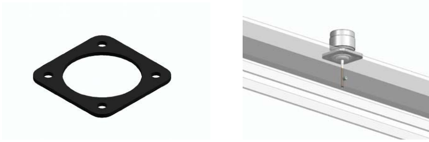
Fig.2-25 Guarnizione per connettore e posizionamento barretta cilindrica
