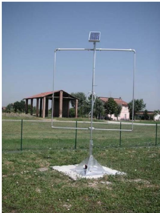
Figura 12: Sensore a loop montato nella piazzola esterna del Centro Visite.
