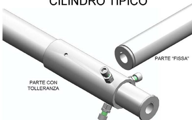
Su di un tubo di diametro di 60,3 mm spessore 2,9 mm di lunghezza 9505 mm è saldata in testa una boccola dotata di una sede per linguetta, necessaria per il collegamento sul riduttore. Questo lato dell'albero viene sempre collegato sul riduttore del cilindro a Nord.
