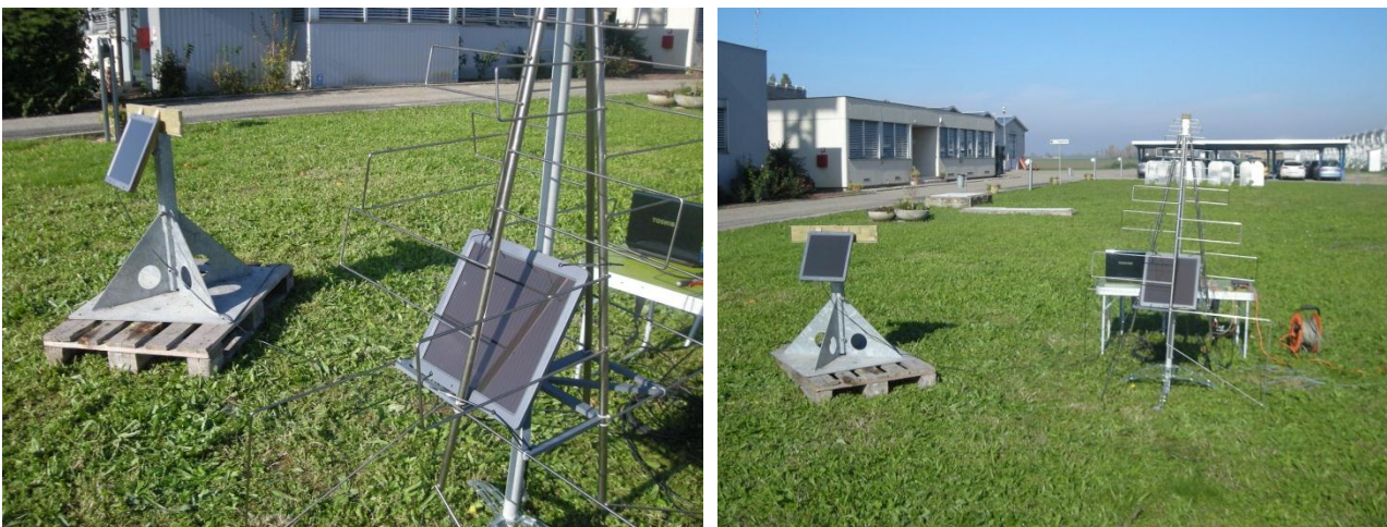
Figura 22. Pannelli solari installati per la misura.
