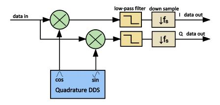
Fig. 16: DDC schematic
