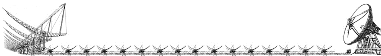
Fig. 1 – Schema di un interferometro semplice. \tau_i indica il ritardo strumentale dell'antenna 2 rispetto all'antenna 1 scelta arbitrariamente come riferimento.
