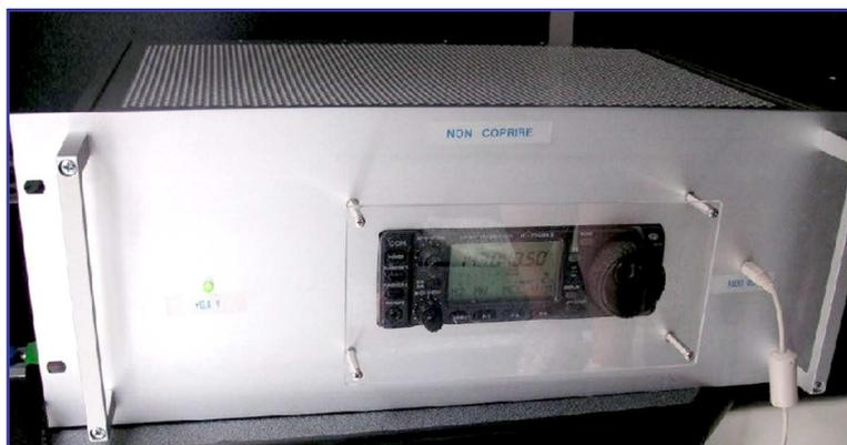
Fig. 12 – Rack da 19” che alloggia il ricevitore ICOM e l'alimentatore.
