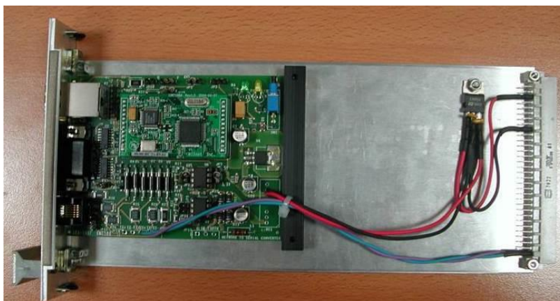
Figura 9 – Cablaggio scheda Ethernet
