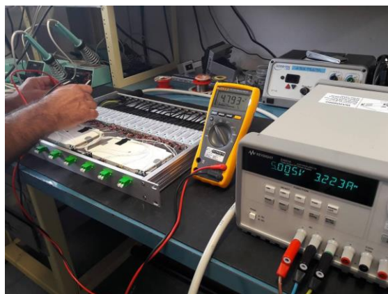
Figura 20 – Misura assorbimento del Box e caduta di tensione barra alimentazione
